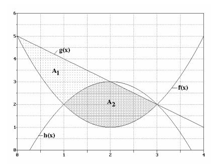
Entsprechend der Aufgabenstellung soll die Fläche von den **drei** Funktionen begrenzt sein. Daraus folgt dann aber, daß zwei verschiedene Flächen möglich sind, A<sub>1</sub> und A<sub>2</sub>. Diese Flächen müssen getrennt betrachtet werden, denn A=A<sub>1</sub>+A<sub>2</sub> wird nur von **zwei** Flächen begrenzt!
