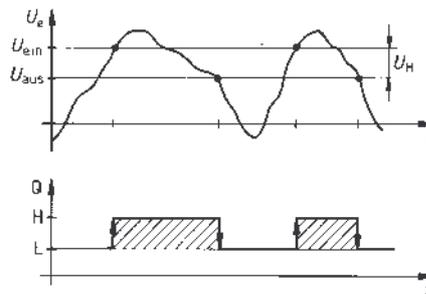
**Schaltung: Schmitt – Trigger mit OPV**
