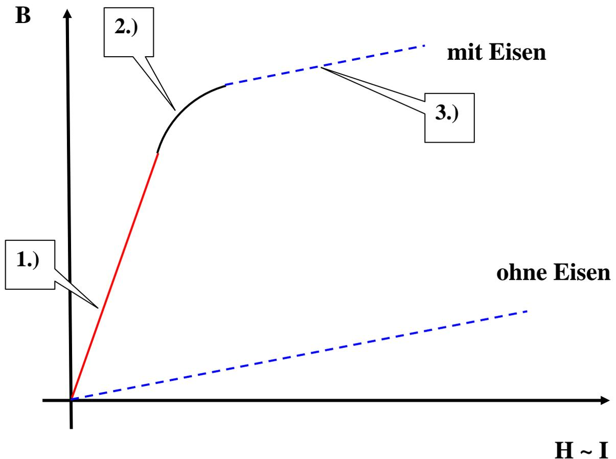
**zu 1.)** Im Magnetfeld der stromdurchflossenen Spule richten sich die Elementarmagnete schnell aus. Die Flussdichte steigt schnell an.
