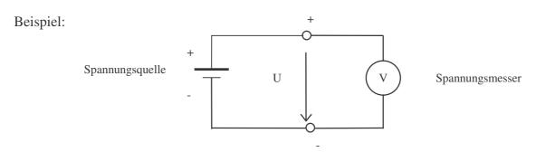
Da es verschiedene Spannungsarten gibt, muss man diese Eigenart bei der Messung beachten. So muss man z.B. den Wahlschalter auf Gleich- oder Wechselspannung einstellen und bei Gleichspannung auf die Polarität achten.
